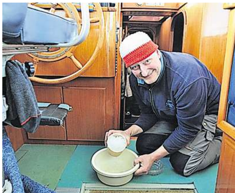
Harald Paul reinigt den Ansaugfilter - bei den Eisdurchfahrten setzt es den Filter immer wieder zu.
