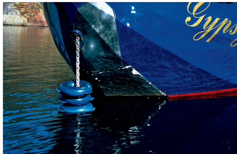
Gut geschützt: Unter dem Bug wurde der Rumpf des Stahlverdrängers mit 15 mm starken, zusätzlich mit GFK überzogenen Hartholzplatten gegen Eisberührungen verstärkt.
