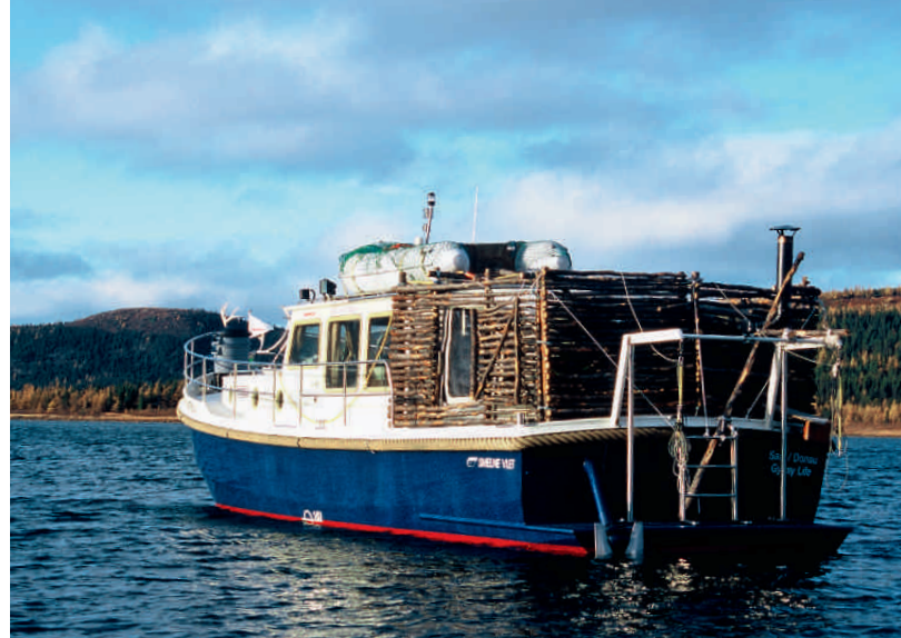
Winterfest: Ein Gerüst aus jungen Baumstämmen, das später zusätzlich mit Moos abgedichtet wird, verstärkt das Verdeck über der Plicht. Auch ein Holzofen wird im Heck aufgestellt.
