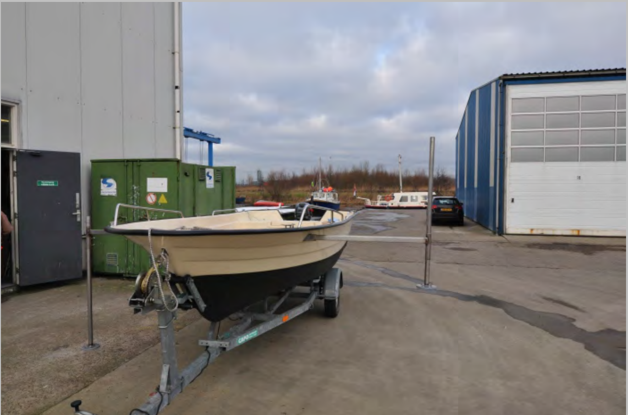
An Backbord steht die Stütze nach oben und ist weit raus gezogen. Hier können Schlepplein für den Fischfang umgeleitet werden, damit sie sich nicht im Antrieb verfangen können.
