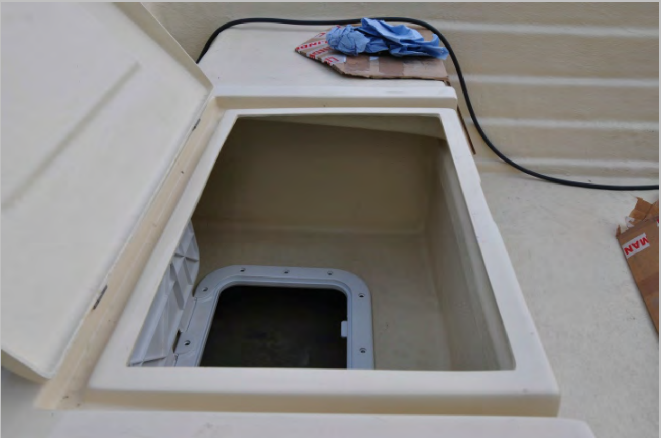
Diese zusätzliche Luke im Stauraum ermöglicht eine Kontrolle des doppelten Bodens.
