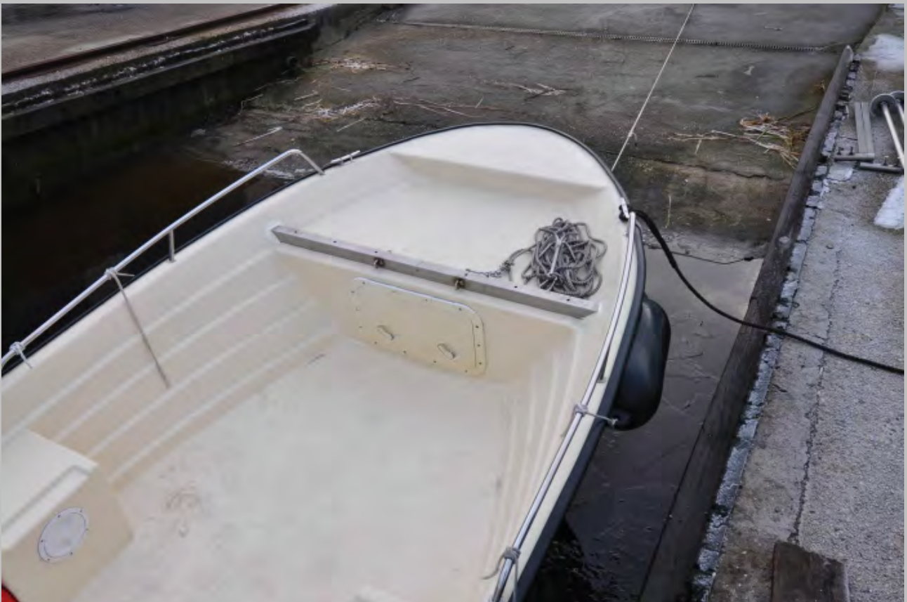
Bug und seitliche Luken ermöglichen ein trimmen des Bootes und weitere Ausrüstung zu verstauen.
